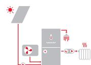
Solární systém s kombinovanou akumulační nádrží HSK pro přípravu teplé vody a přitápění, pro systémy s tepelnými čerpadly
