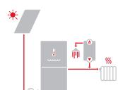
Solární systém s kombinovanou akumulační nádrží HSK pro přípravu teplé vody a přitápění, pro systémy s kotli
